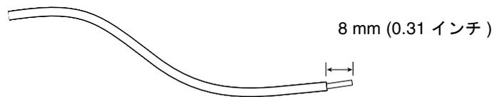
図 3-2 配線からの絶縁被膜の除去
