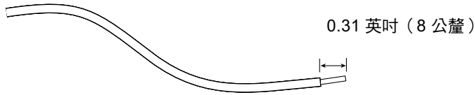
圖 3-2 剝離導線的絕緣材料
