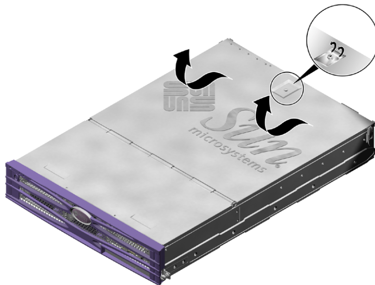
図 1-5 カバーの背面部分の留め具の位置
