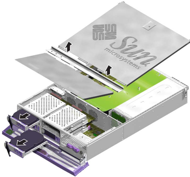
그림 1-21 인터페이스 보드에 접근하기 위한 덮개 어셈블리 및 하드 드라이브 제거
