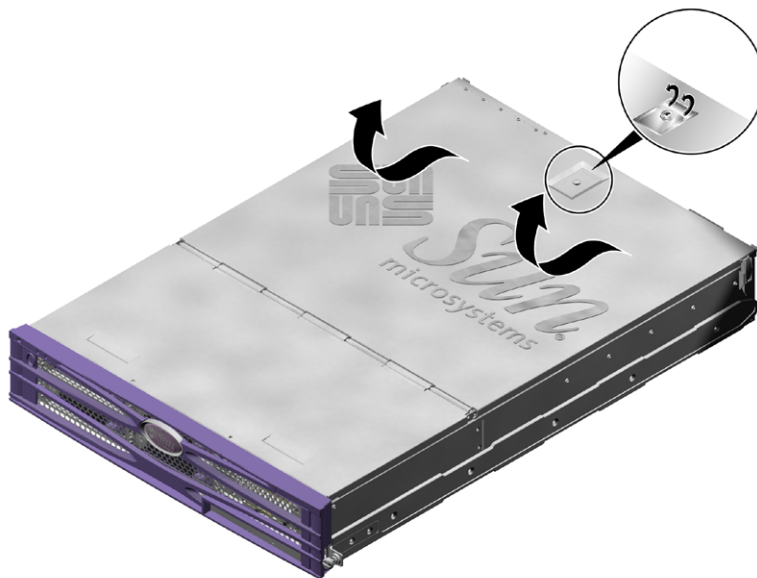
图 1-5 后部盖板上卡锁的位置
