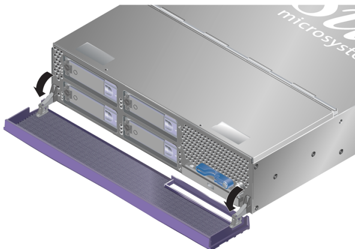
FIGURE 2-2 Ouverture de la façade (serveur Sun Fire V240)
