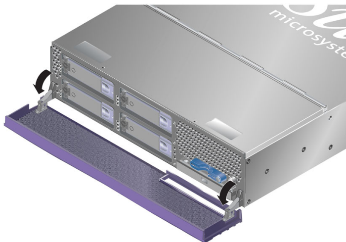
图 2-2 打开挡板（Sun Fire V240 服务器）
