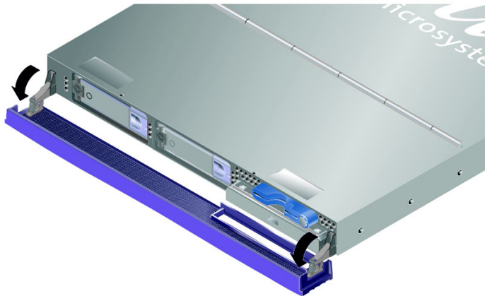
图 2-1 打开挡板（Sun Fire V210 服务器）
