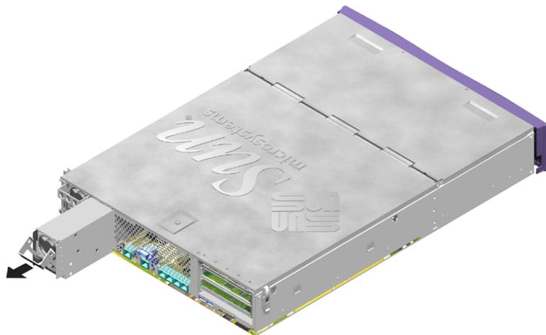
**ABBILDUNG 1-13** Ausbau einer Stromversorgungseinheit beim Sun Fire V240
