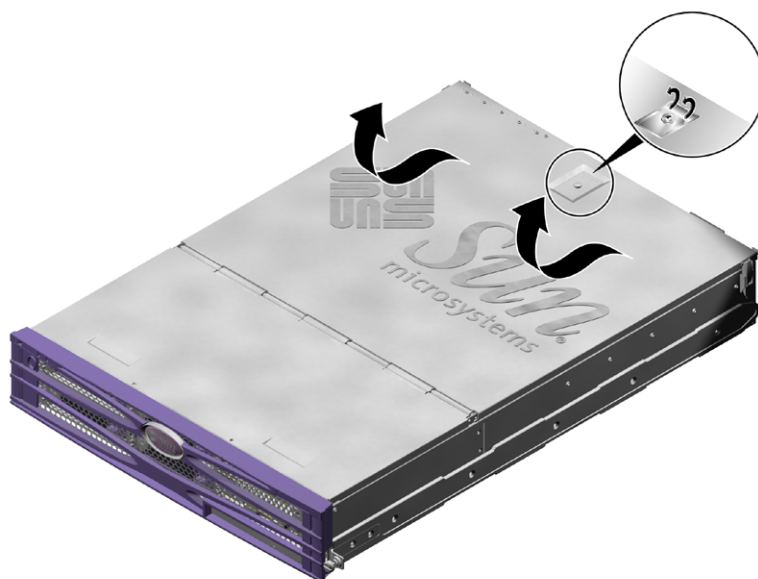
РИСУНОК 1-5 Расположение защелки на задней части крышки
