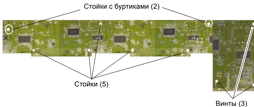
РИСУНОК 1-23 Расположение стоек и винтов нижней платы интерфейса
