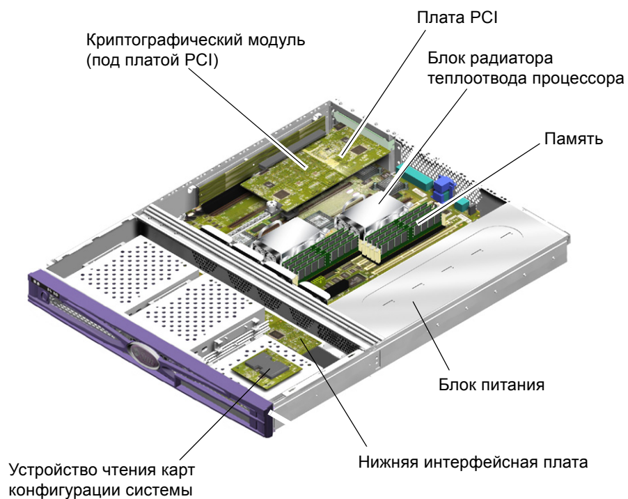
РИСУНОК 1-7 Расположение основных компонентов сервера Sun Fire V210
