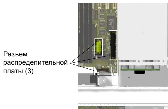
РИСУНОК 1-14 Расположение разъемов распределительной платы на системной плате.
