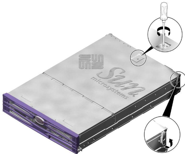
圖 1-4 外殼背面部份的鎖定螺絲和側邊鉤手的位置
