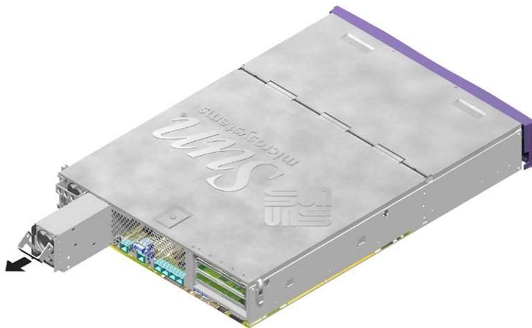
圖 1-13 移除 Sun Fire V240 伺服器上的 PSU
