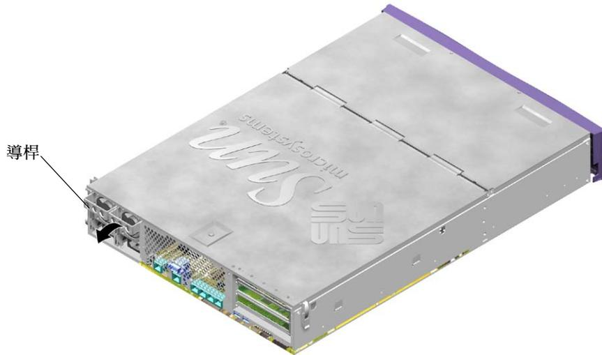
圖 1-12 Sun Fire V240 伺服器上電源供應器裝置的導桿
