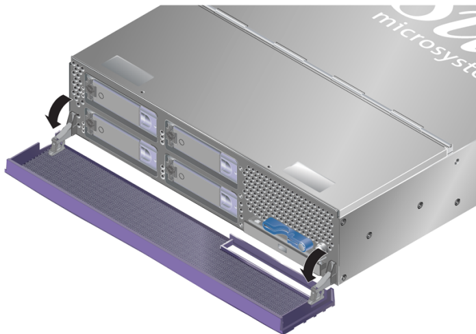
ABBILDUNG 2-2 Öffnen der Frontblende (Sun Fire V240-Server)
