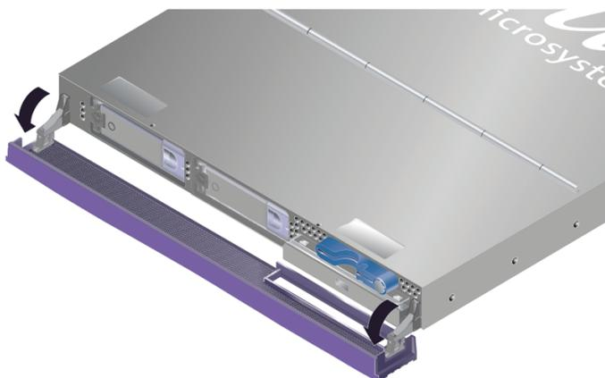
**FIGURA 2-1** Apertura del frontalino (server Sun Fire V210)
