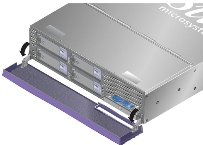
**FIGURA 2-2** Apertura del frontalino (server Sun Fire V240)
