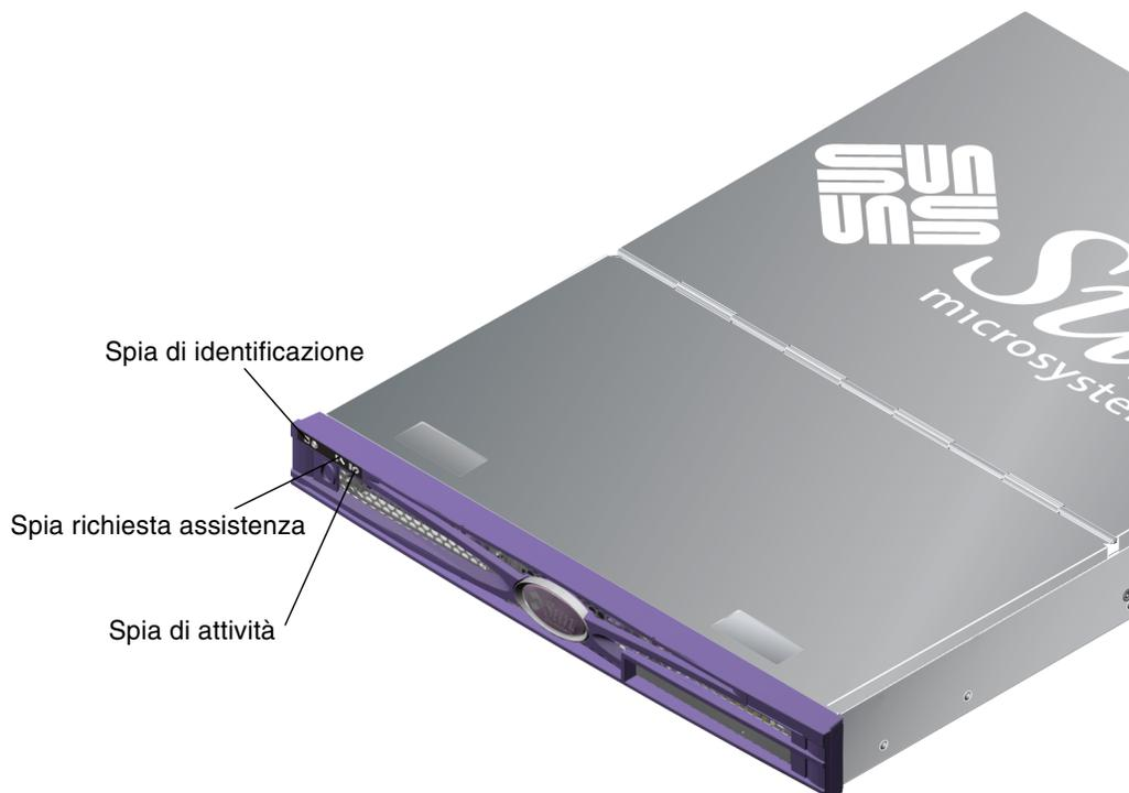
**FIGURA 1-3** Posizione degli indicatori di stato (server Sun Fire V210)
