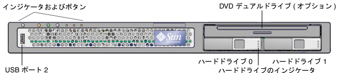
図 1 Sun Fire V215 サーバーのフロントパネル
