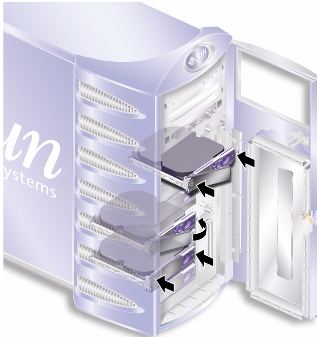
FIGURA 2-3 Inserimento di un'unità disco rigido
