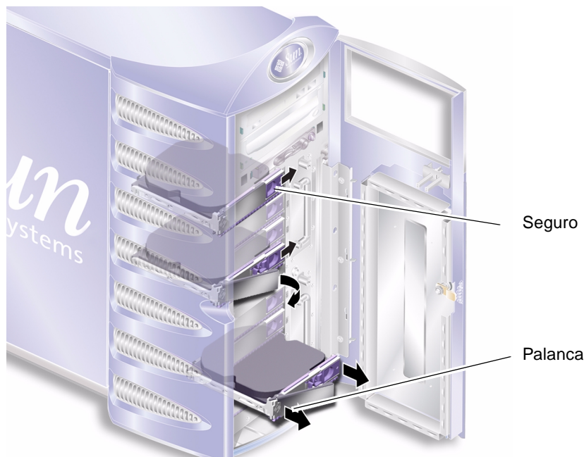
FIGURA 2-2 Extracción de una unidad de disco duro
