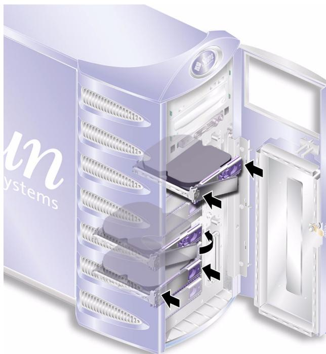
**РИС. 2-3** Установка накопителя на жестких дисках
