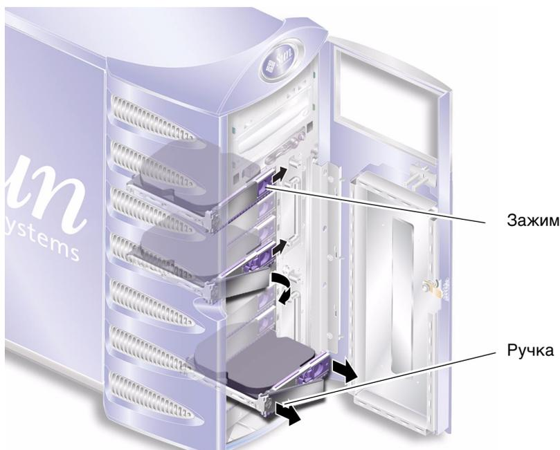
РИС. 2-2 Снятие накопителя на жестких дисках
