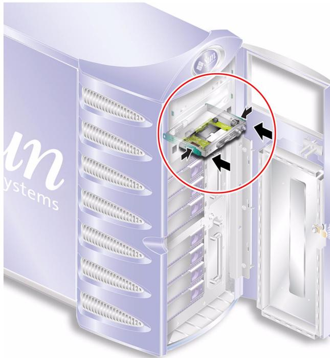
FIGURE 1-11 Remplacement du module de lecture de la carte de configuration système
