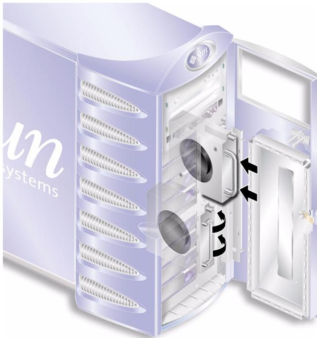
FIGURE 1-33 Réinsertion d'un module de ventilation avant
