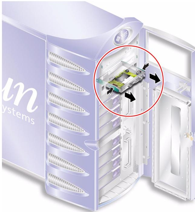
FIGURE 1-10 Retrait du module de lecture de la carte de configuration système
