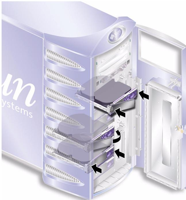
FIGURE 1-7 Insertion d'un disque dur
