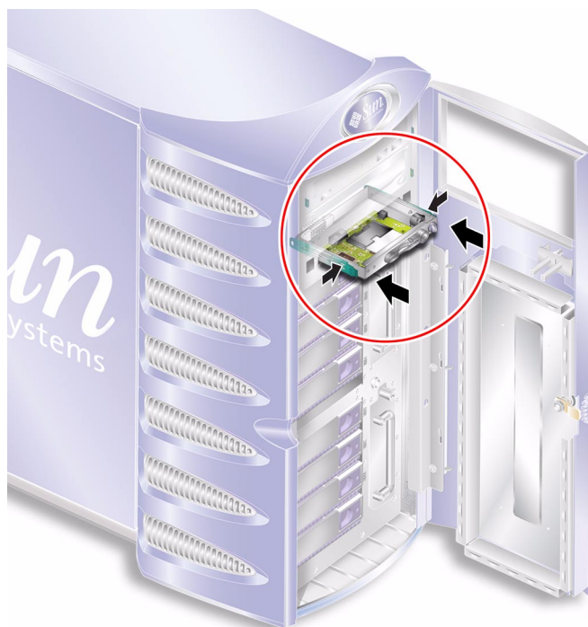
FIGURA 1-11 Sostituzione del modulo del lettore della scheda del configurazione del sistema
