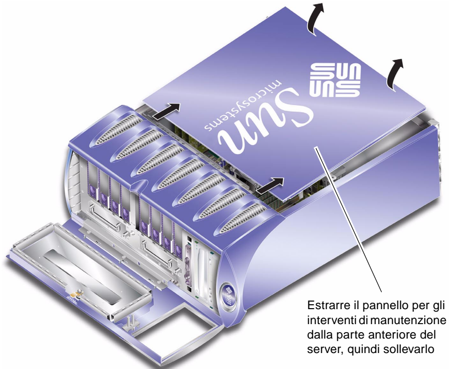
FIGURA 1-4 Rimozione del pannello per gli interventi di manutenzione
