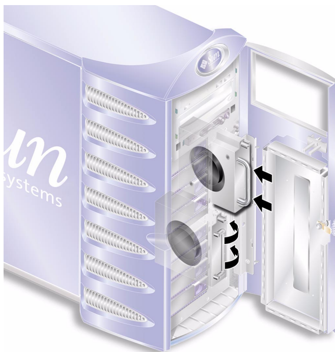
FIGURA 1-33 Sostituzione di un modulo della ventola anteriore
