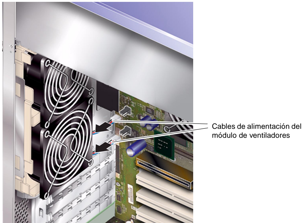
FIGURA 1-17 Desconexión de los cables de alimentación del módulo de ventiladores
