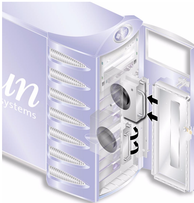
FIGURA 1-33 Reemplazo de un módulo frontal de ventilador
