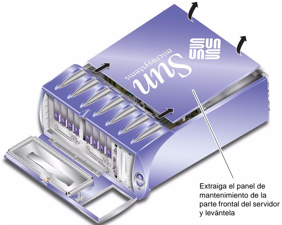
FIGURA 1-4 Extracción del panel de mantenimiento
