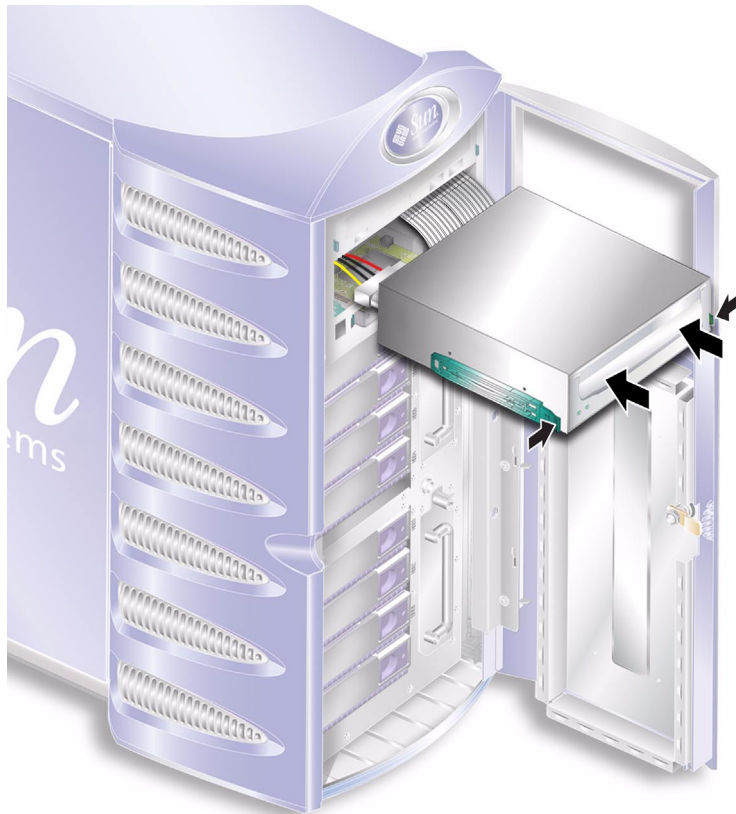
FIGURA 1-28 Instalación de un módulo de unidad de cinta
