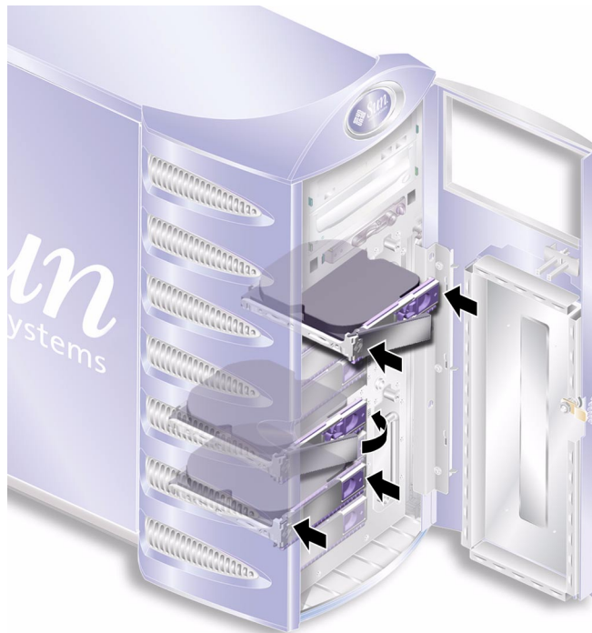
FIGURA 1-7 Colocación de una unidad de disco duro
