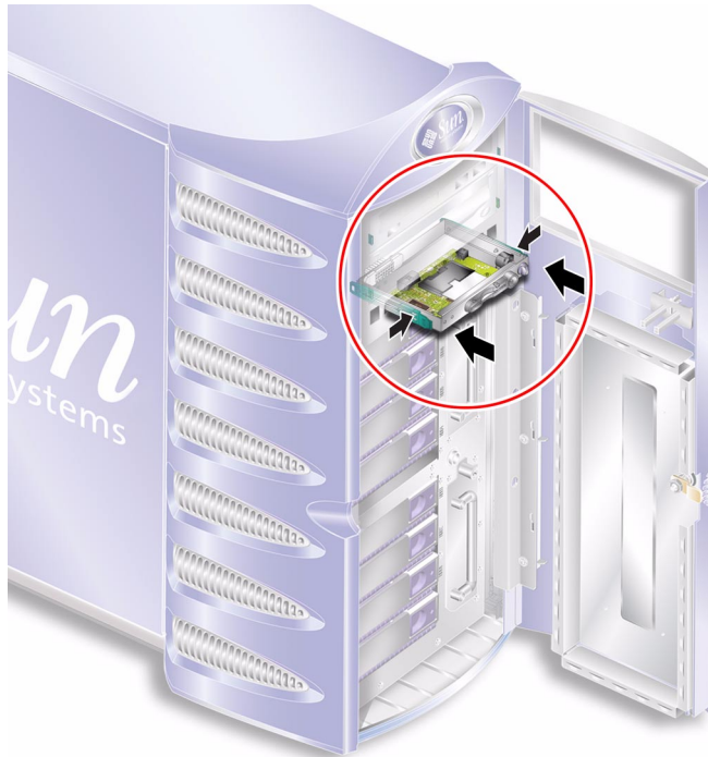
FIGURA 1-11 Reemplazo del módulo lector de tarjetas de configuración del sistema
