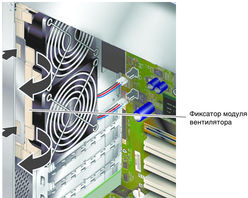
РИС. 1-18 Снятие модуля вентилятора
