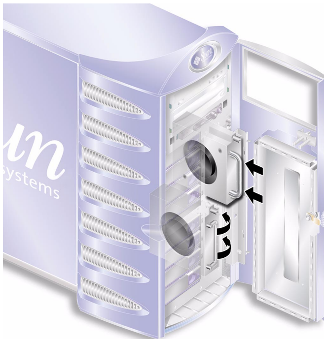
РИС. 1-33 Установка модуля переднего вентилятора на место
