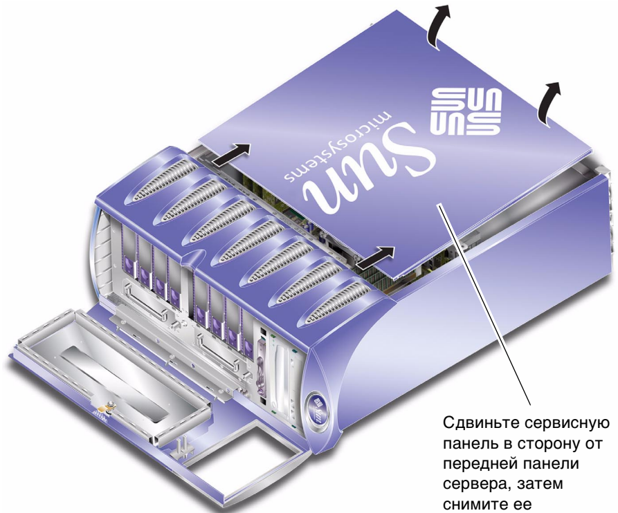
РИС. 1-4 Снятие сервисной панели
