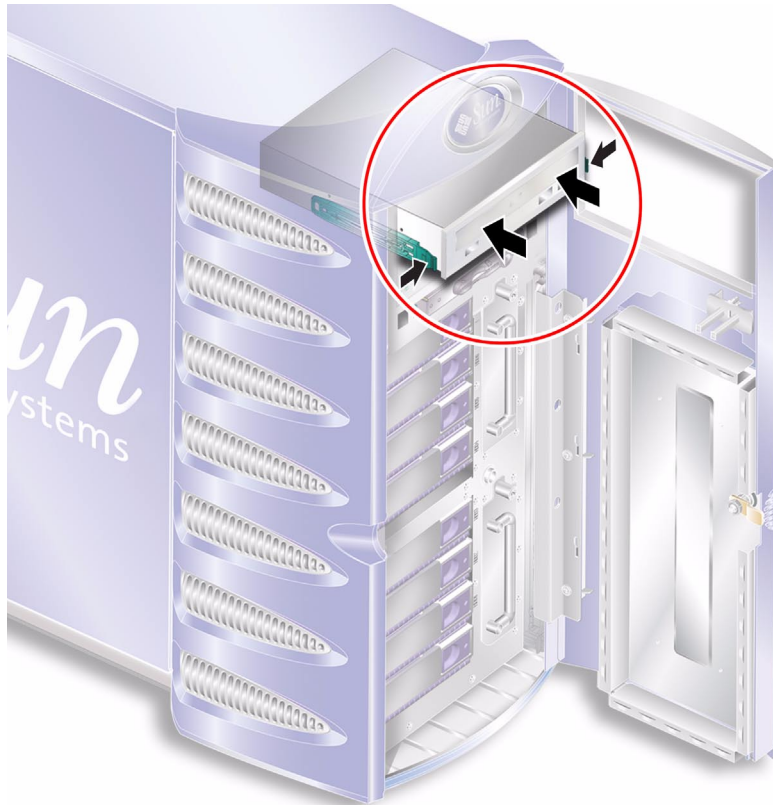
РИС. 1-31 Установка дисковода DVD-ROM на место
