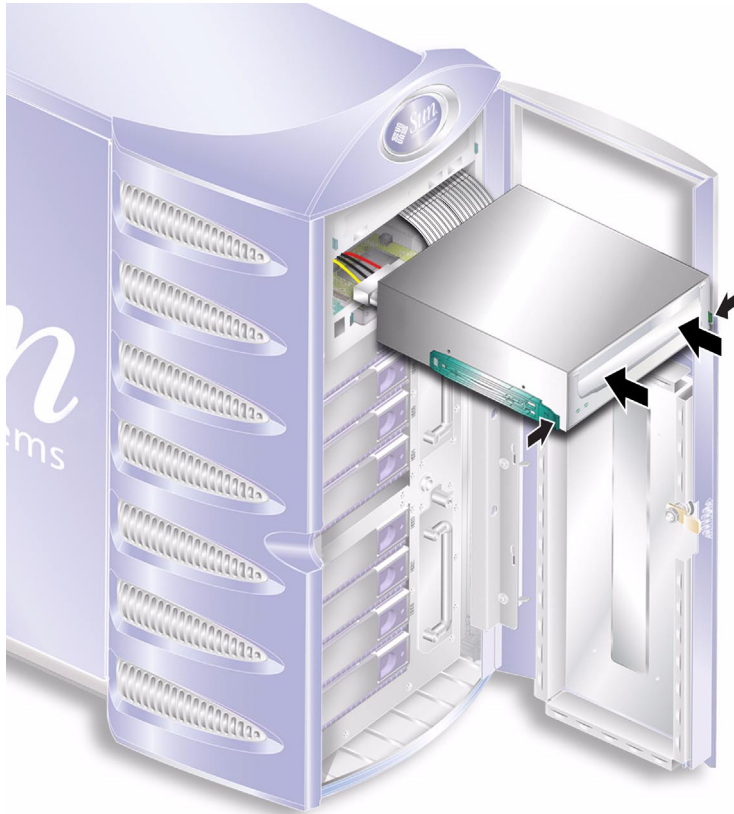
РИС. 1-28 Установка модуля накопителя на магнитной ленте
