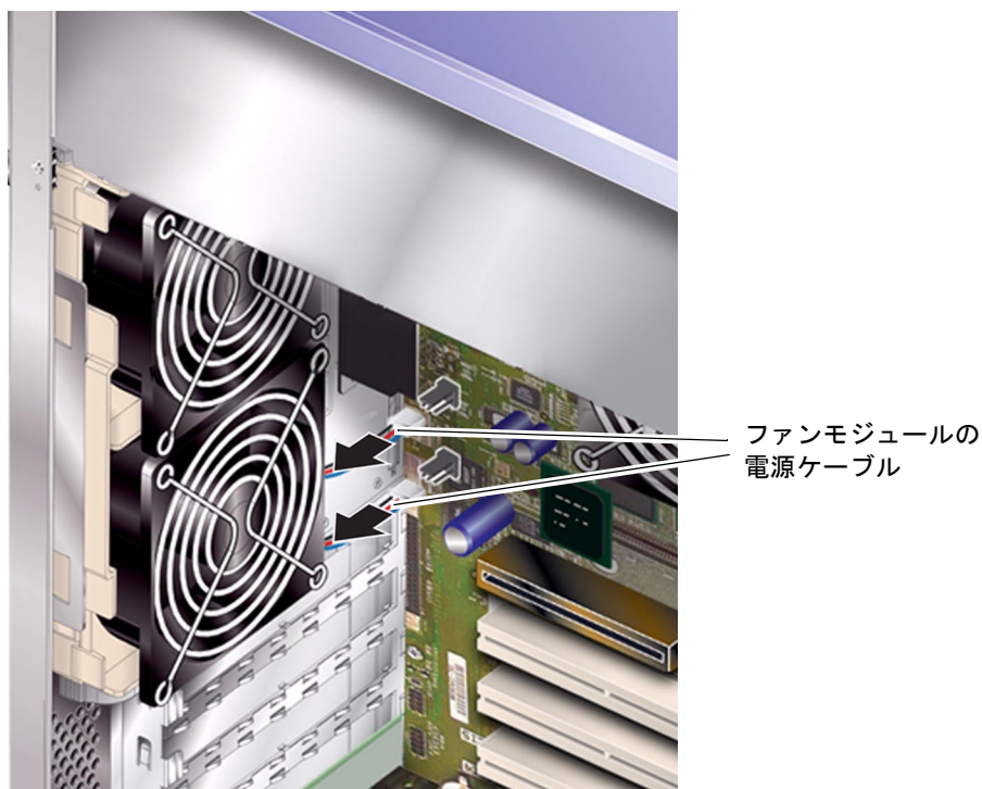
図 1-17 ファンモジュールの電源ケーブルの取り外し
