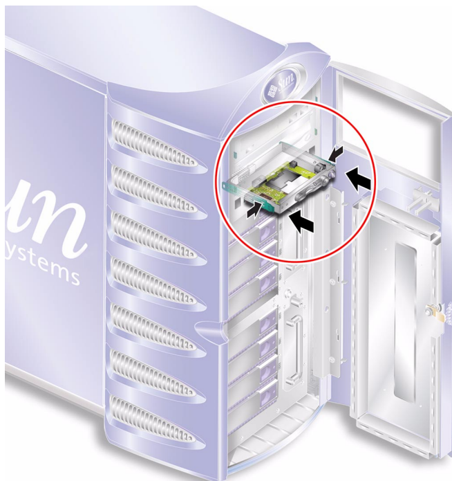
図 1-9 システム構成カードリーダーモジュールの取り付け
