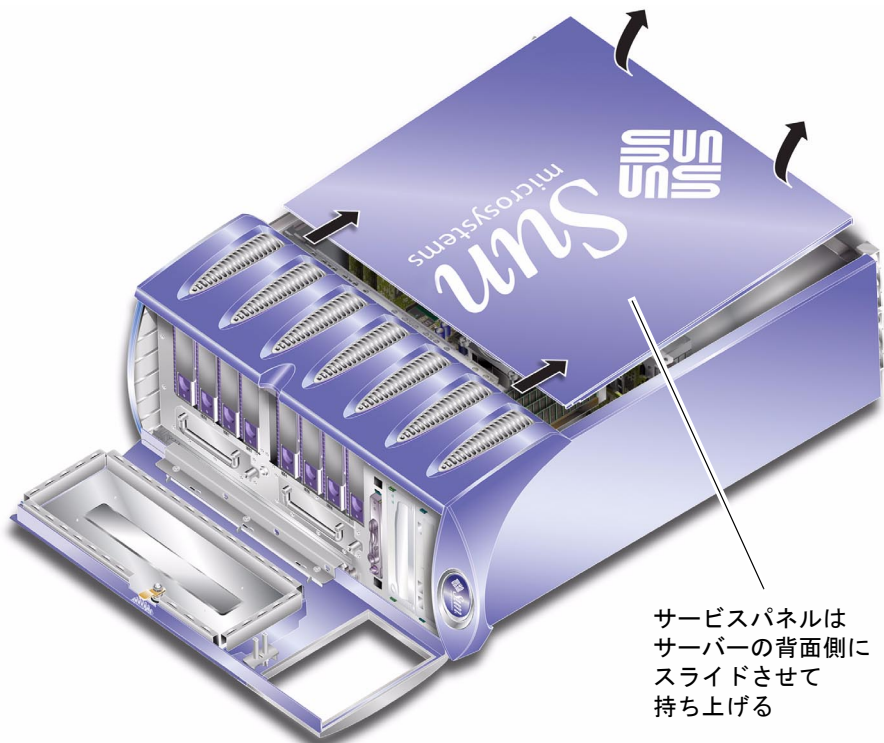
図 1-4 サービスパネルの取り外し
