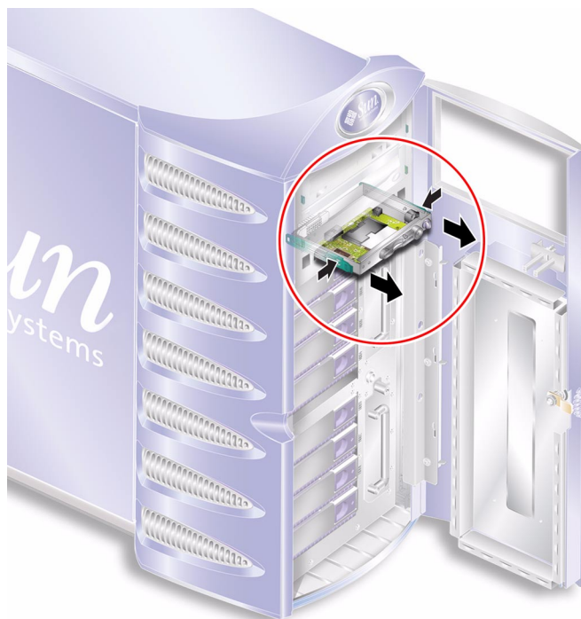
図 1-8 システム構成カードリーダーモジュールの取り外し
