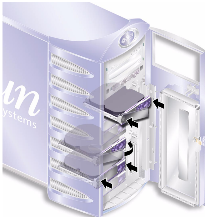
図 1-7 ハードディスクドライブの挿入
