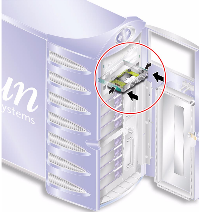
그림 1-11 시스템 구성 카드 관독기 모듈 교체
