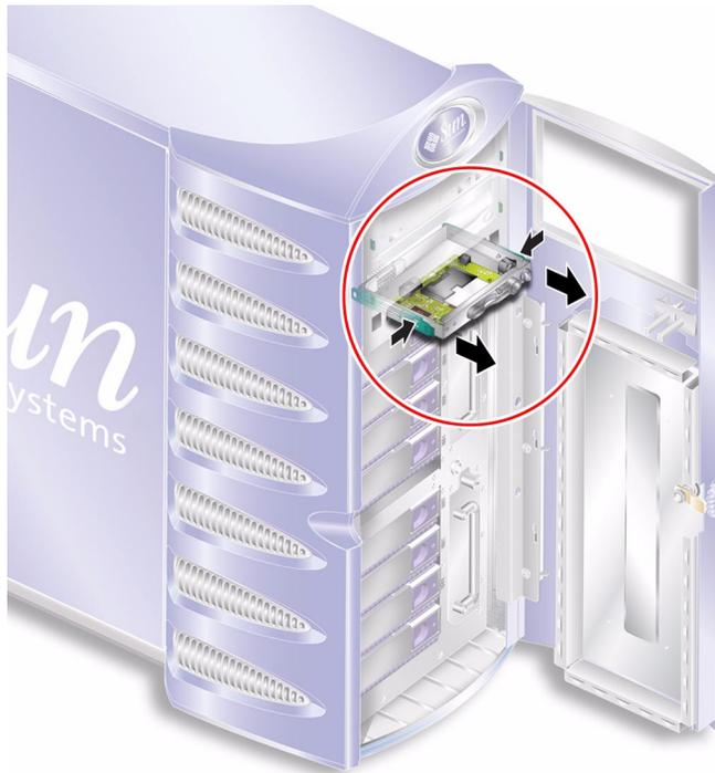
圖 1-10 移除系統組態卡讀取器模組
