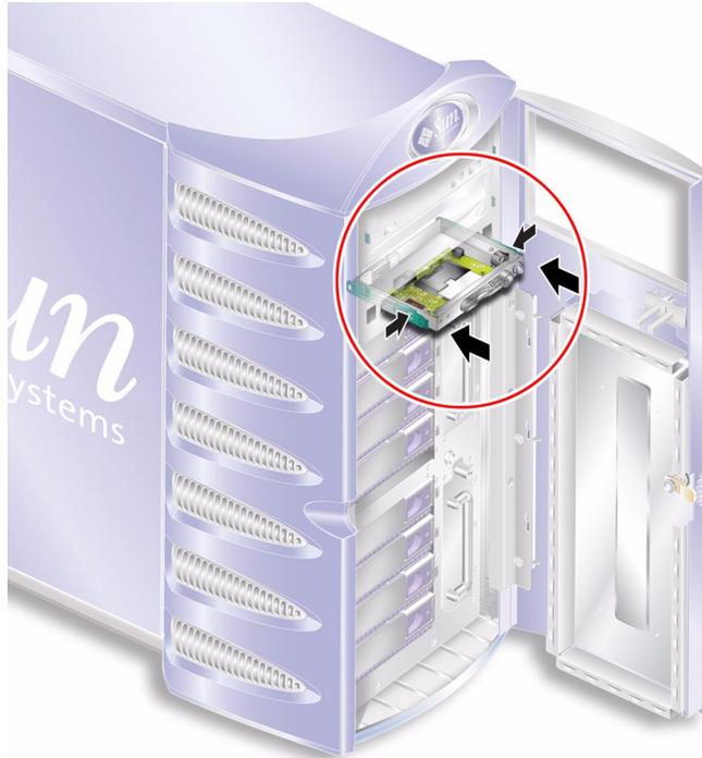
圖 1-11 更換系統組態卡讀取器模組
