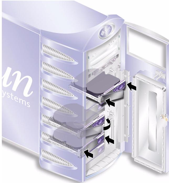
圖 1-7 插入硬碟機
