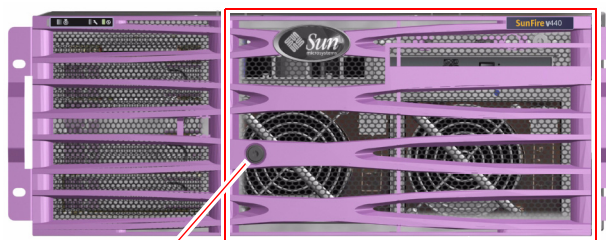
Blocco di sicurezza
