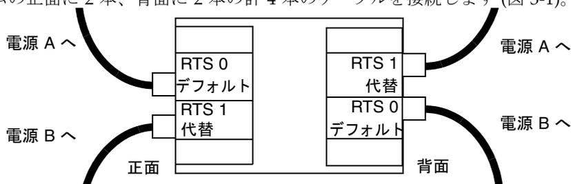
図 3-1 Sun Fire E6900 の構成: 2 つの RTU アセンブリおよび 2 つの独立した AC 電源
