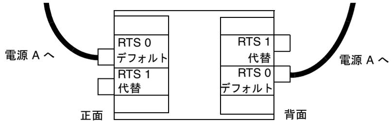
図 3-3 Sun Fire E6900 の構成: 2つの RTU アセンブリおよび1つの AC 電源
