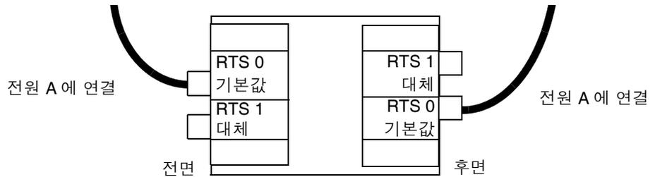
그림 3-3 Sun Fire E6900 Configuration: 2개의 RTU 조립품과 1개의 AC 전원
