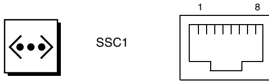
図 B-6 RJ-45 より対線 Ethernet ソケット
