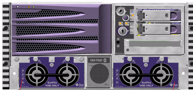
Position von Stromversorgungseinheit 0
