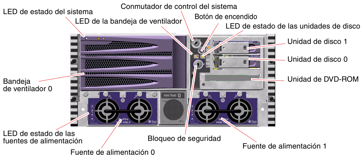
FIGURA 2-1 Funciones del panel frontal del servidor Sun Fire V490
