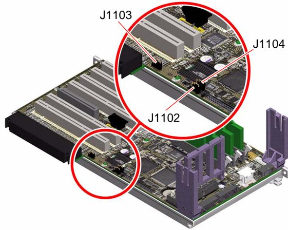
圖 3-6 PCI 插槽板上的硬體跳接器
