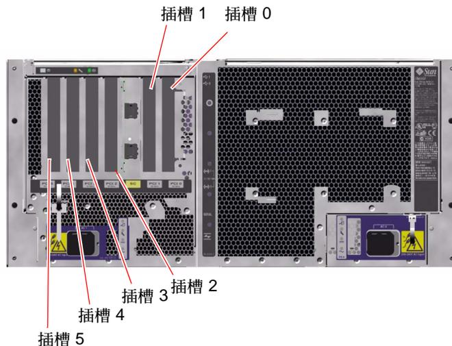
圖 3-2 PCI 插槽
