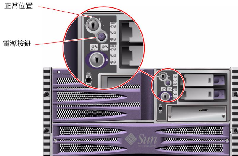
5. 按下位於系統控制開關下方的電源按鈕，即可開啓系統電源。
