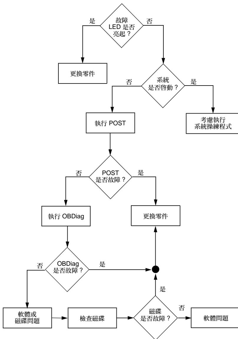
圖 10-1 選擇工具以隔離硬體故障
