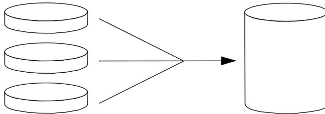
使用這種方法，串連起來的磁碟會依序填入資料，待第一個磁碟沒有空間時才寫入第二個磁碟，第二個磁碟沒有空間時才寫入第三個磁碟，依此類推。
