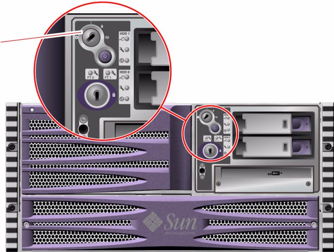
圖 2-2 位在鎖定位置之具有四個位置的系統控制開關
