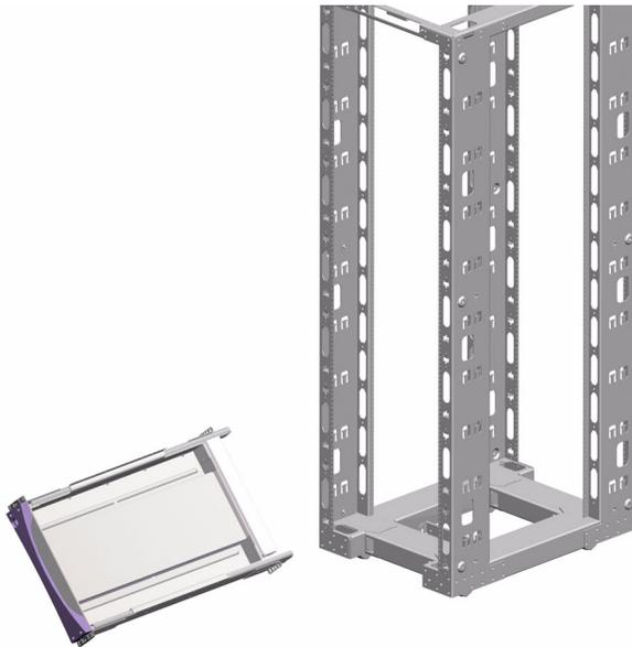
**b. Fije los soportes frontales en los rieles frontales del mueble utilizando cuatro tornillos 10-32.**
