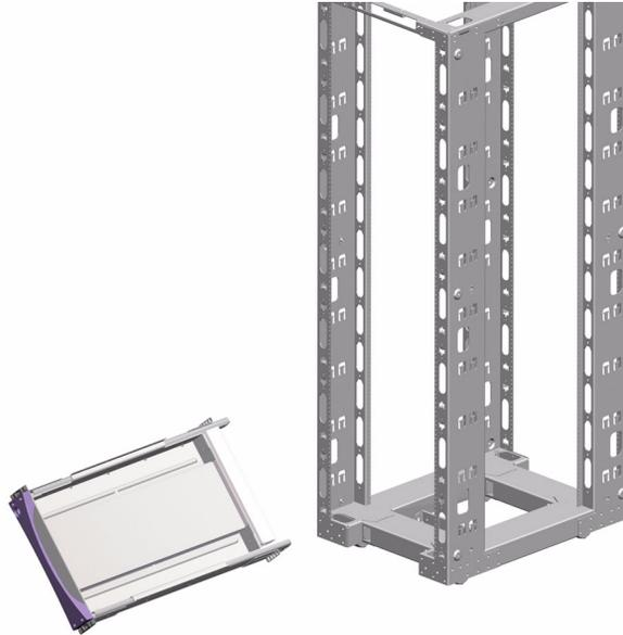
**b. Fije los soportes frontales en los rieles frontales del mueble mediante cuatro tornillos M6.**
