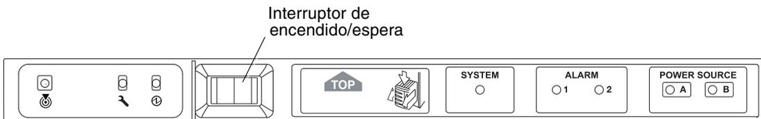
**FIGURA 2-1** Interruptor de encendido/espera del servidor Netra 1290
