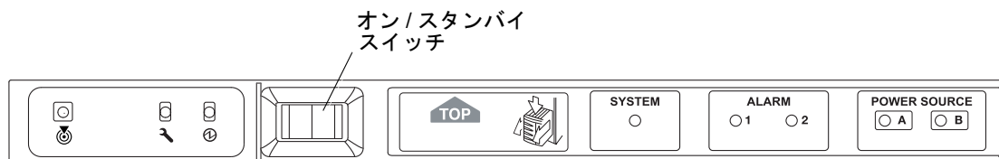
図 2-1 Netra 1290 サーバーのオン/スタンバイスイッチ
