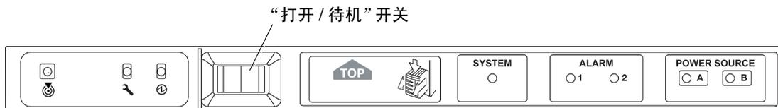
图 2-1 Netra 1290 服务器的“打开/待机”开关
