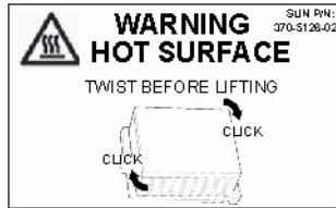
FIGURA 3-33 Dissipatore di calore con frecce di rotazione in senso orario
