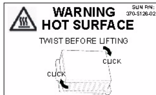
FIGURA 3-33 Disipador de calor con flechas en el sentido de las agujas del reloj
