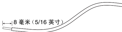
图 4-11 剥去电线上的绝缘层
