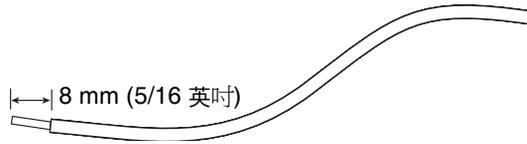
圖 4-11 剝除電線絕緣皮
