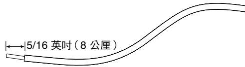
圖 5-47 剝去電線絕緣層
