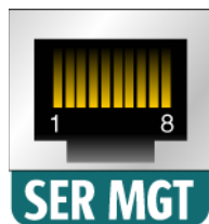
FIGURA 4-1 Puerto serie de administración del procesador de servicios
