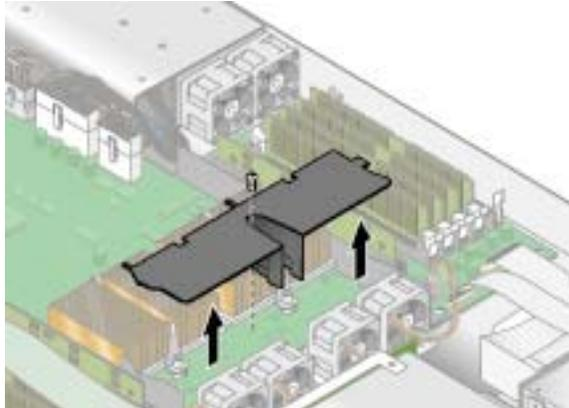
圖 3-29 移除中央空氣檔板
