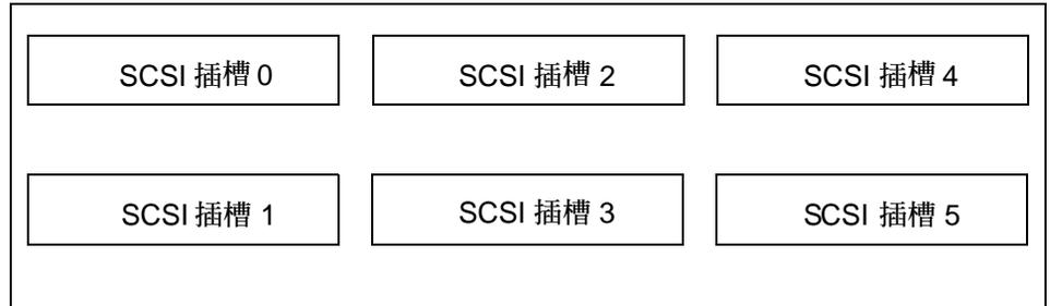
圖 4-3 HDD 的 SCSI 插槽編號
