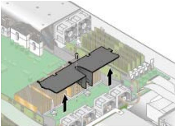
圖 3-9 移除中央空氣阻板
