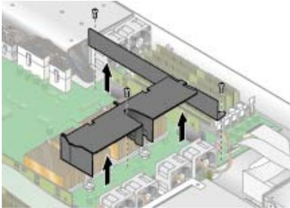
圖 3-18 拆除中央和側空氣阻板
