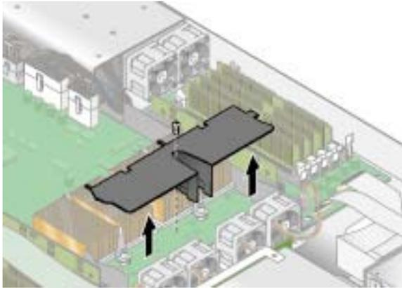
圖 3-21 拆除中央空氣阻板
