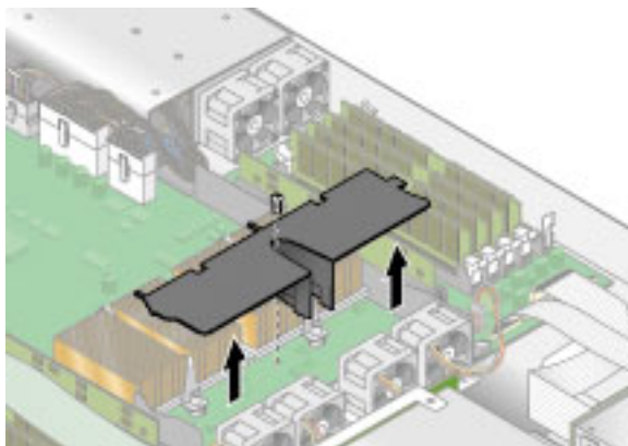
图 3-21 拆除中央气流隔板
