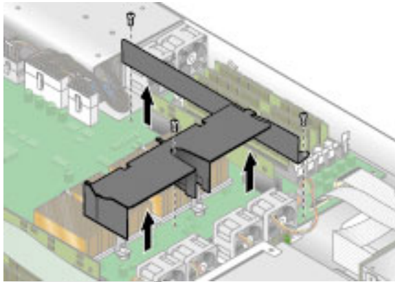
图 3-18 拆除中央和侧面气流隔板
