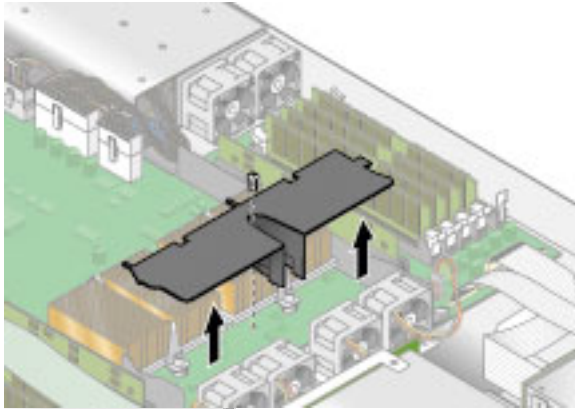
图 3-29 拆除中央气流隔板
