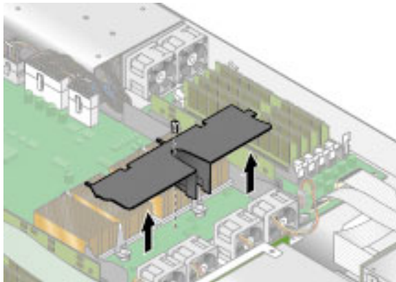
图 3-9 拆除中央气流隔板
