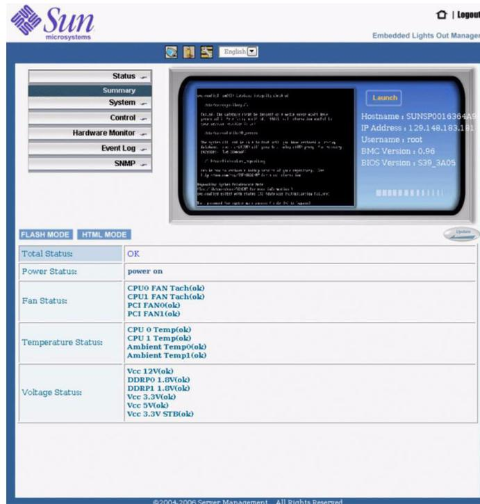
圖 6-2 Embedded LOM 系統狀態螢幕
