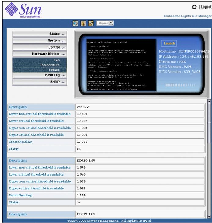
圖 4-7 硬體監視器功能表的電壓子功能表
