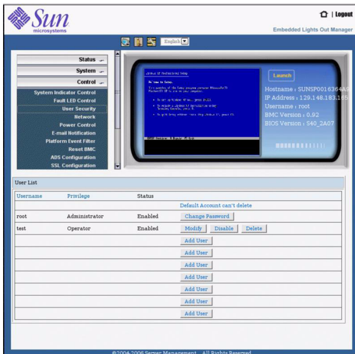
図 5-3 Embedded LOM ソフトウェアによるユーザーセキュリティの制御
