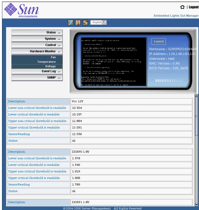
図 4-7 「Hardware Monitor (ハードウェア監視)」メニューの「Voltage (電圧)」サブメニュー
