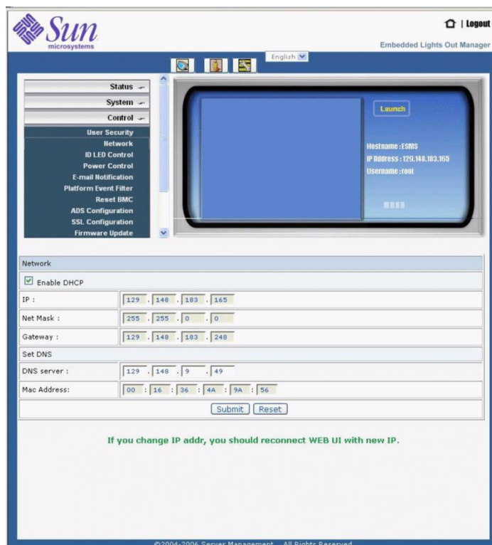
FIGURE 3-2 Sous-menu Network (Réseau) du menu Control (Contrôle) de l'interface Embedded LOM (Windows)
