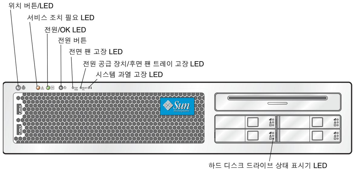
그림 C-1 Sun Fire X4200 서버 전면 패널 LED
