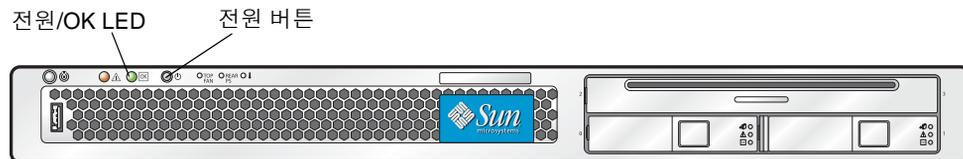
그림 3-1 전원 버튼 및 전원/OK LED 위치
