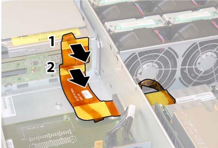
그림 4-36 DVD 드라이브 및 HDD 백플레인에서 플렉스 케이블 분리
