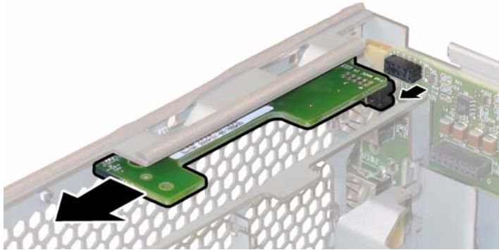
ABBILDUNG 4-26 Entfernen der Anzeigenplatine
