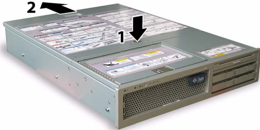
ABBILDUNG 4-2 Abnehmen der Hauptabdeckung
