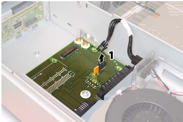
ABBILDUNG 4-63 Trennen der hinteren Lüfterschublade von der Stromverteilungsplatine
