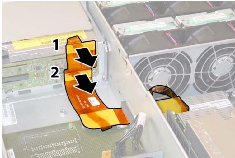
ABBILDUNG 4-36 Ziehen des Flex-Kabelsteckers aus dem DVD-Laufwerk und der HDD-Anschlussleiste
