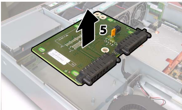
ABBILDUNG 4-65 Ausbauen der Stromverteilungsplatine
