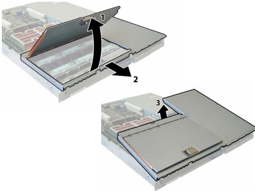
ABBILDUNG 3-4 Abnehmen der Frontabdeckung
