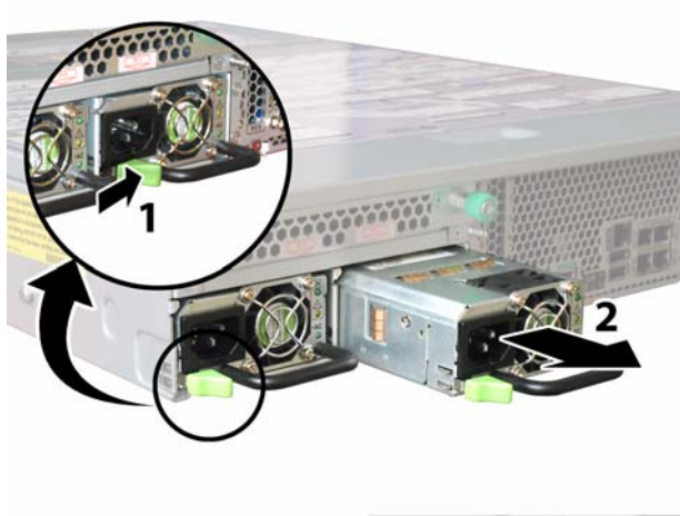
ABBILDUNG 4-59 Ausbauen eines Netzteils
