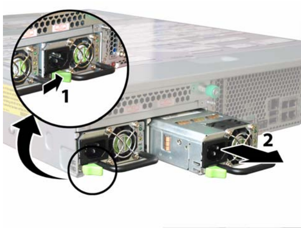
ABBILDUNG 4-58 Ausbauen eines Netzteils
