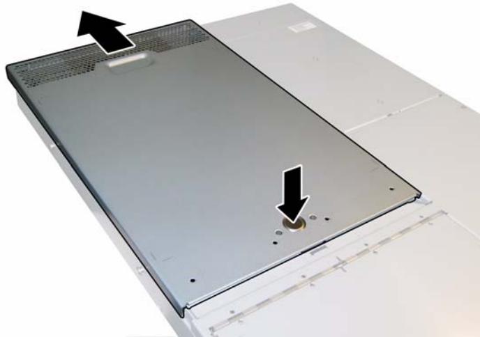
ABBILDUNG 3-2 Abnehmen der Hauptabdeckung
