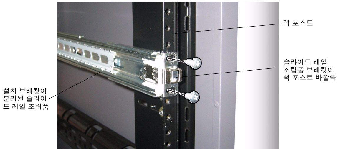
그림 1-3 랙 포스트에 슬라이드 레일 조립품 부착
