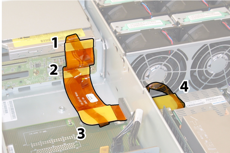
圖 4-62 斷開軟纜線的四個連接器
