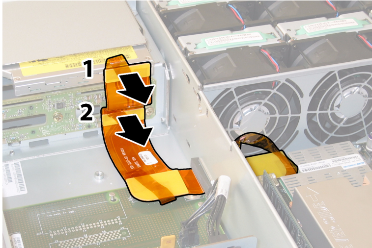
圖 4-36 從 DVD 光碟機和 HDD 背板上斷開軟纜線
