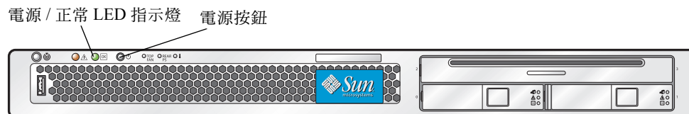
圖 3-1 電源按鈕和電源 / 正常 LED 指示燈位置
