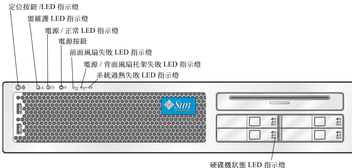
圖 C-1 Sun Fire X4200 伺服器前板 LED 指示燈
