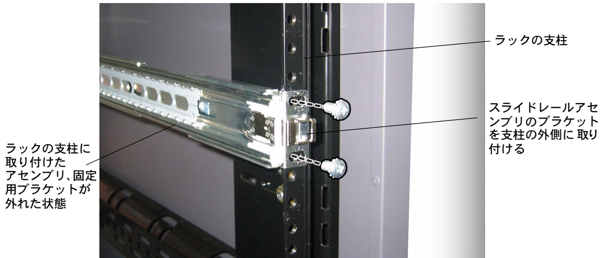
図 1-3 スライドレールアセンブリをラックの支柱に取り付ける
