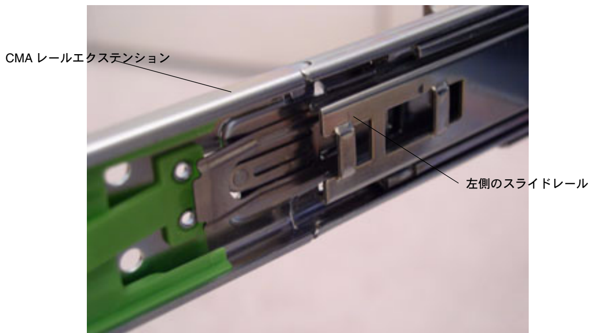
図 1-6 左側のスライドレールに正しく装着された状態の CMA レールエクステンション
